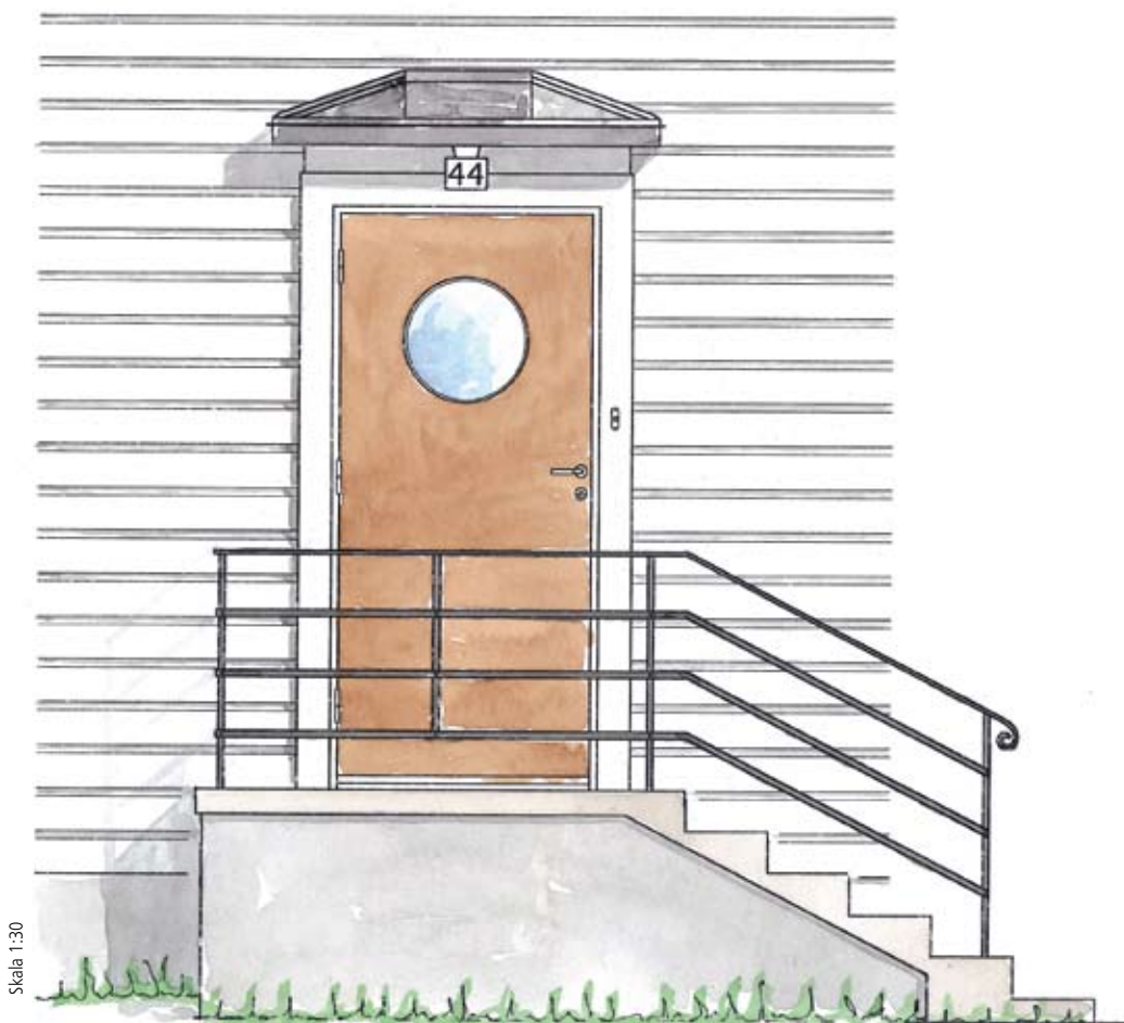
Ett entréparti med skärmtak på dolda konsoler. Trappan är av betong och räcket av plattstål har målats ljusgrått. Den runda glasningen i den släta ytterdörren är inspirerad av fartygsdesign.
