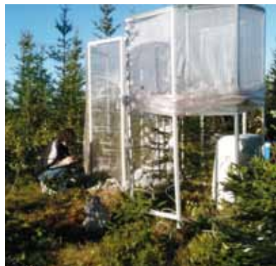
Bilden visar ett försök där forskarna tillför kol 13-koldioxid till granar i fält för att studera hur kolet fördelas mellan olika delar av trädet och mellan olika processer.
